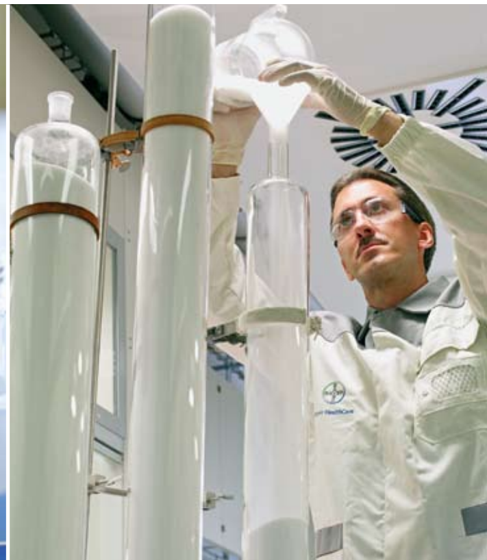
Wirkstoffreinigung: Bodo Röhr befüllt eine Chromatographiesäule, die zur Trennung von Substanzgemischen und Aufreinigung von Reaktionsprodukten dient.
