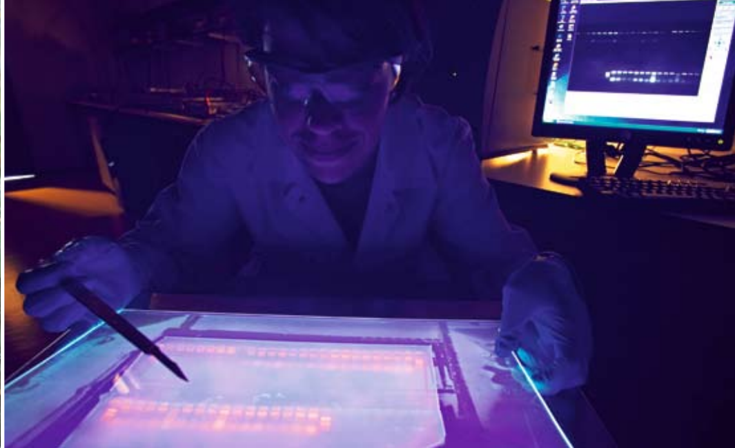
Ergebnisse bei Licht besehen: Mittels Polymerase-Kettenreaktion (engl. Polymerase Chain Reaction, PCR) vervielfältigte DNA-Fragmente der Rapsorten werden durch UV-Licht sichtbar gemacht. So ist eine Vorhersage über die Ölzusammensetzung der analysierten Pflanzen möglich.
