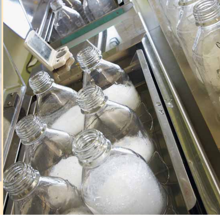
Malaria-Experten: Dr. Karin Horn und Dr. Rainer Sonneck (v. li.) haben die neuen Netze entwickelt. Um die Haltbarkeit des darin enthaltenen Wirkstoffs zu prüfen, waschen die Forscher das Gewebe im Labor (re.).
