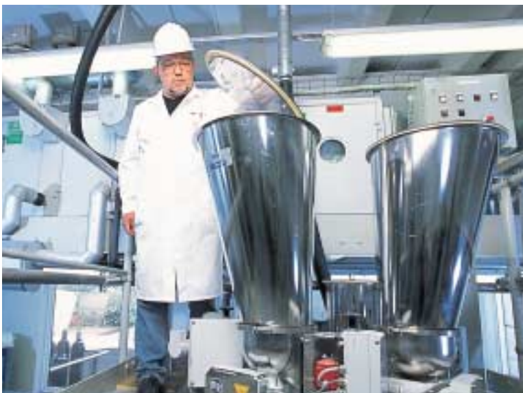
Nachschub: Ralf Hönow befüllt den Extruder zum Mischen der beiden Kunststoffkomponenten.
