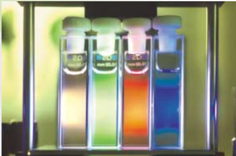
Farbenpracht: Bei Bestrahlung mit speziellem UV-Licht fluoreszieren die Nanophosphore (hier in einer Dispersion) in unterschiedlichen Farben.
