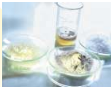
Zutaten: Bei der Produktion des Kunststoffs gibt man Schichtsilikat und Caprolactam dem Polymerisationsprozess zu.
