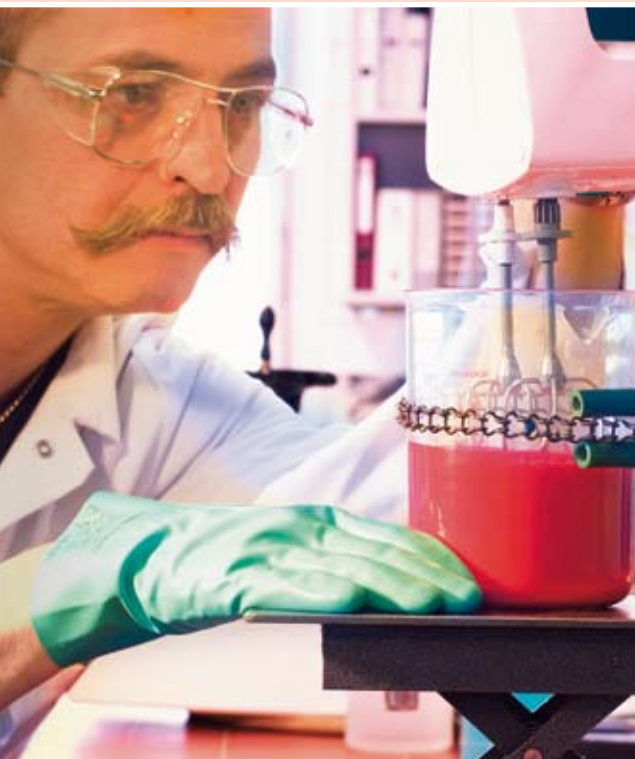
Hauchdünner Schaum: Für Versuche quirlt Bruno Stübßen (l.) eine Polyurethandispersion zur Herstellung von Kunstleder. Mit der Beschichtungsanlage trägt Jonuz Mustafi (r.) den PUR-Schaum als millimeterdünne Schicht auf und prüft die Haftung zum textilen Substrat (weiß).
